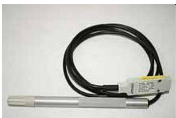
Un cas impossible : la réponse «parabolique» mais reproductible d'année en année de ce thermomètre ne peut pas être corrigé par le simple réglage d'offset et de pente, seuls paramètres accessibles pour un ajustage.
