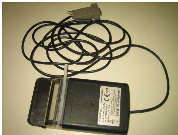
Figure 17 : exemple de lecteur d'index de compteur optique
